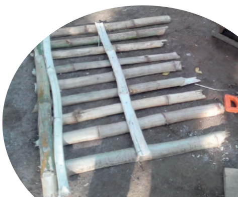
Fotos 4 y 5. Rejas de desbaste en Kimpese, R.D. de Congo, diseño grupo Tar, autoconstrucción comunitaria.
