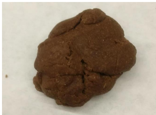
Figura 24: Masa de bagazo:glicerina (1:1) tras el proceso de mezclado.
