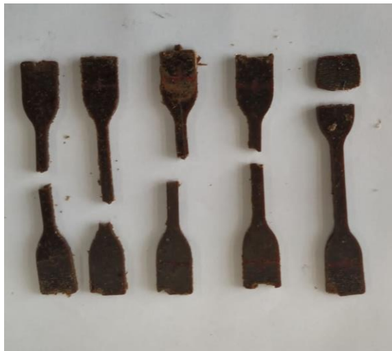
Figura 40: Probetas de pajarita tras su ruptura en ensayo de tracción.
