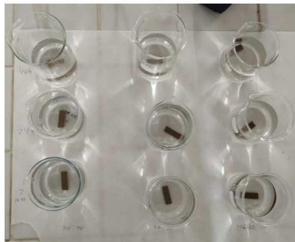
Figura 31: Ensayo de absorción de agua.
