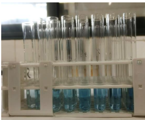
Figura 17: Muestras de estudio y patrón preparadas mediante el método de Lowry.
