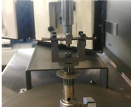
Figura 30: Probeta rectangular sometida a ensayo de flexión.
