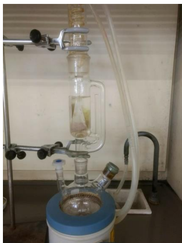
Figura 14: Equipo Soxhlet en funcionamiento para la extracción de lípidos.
