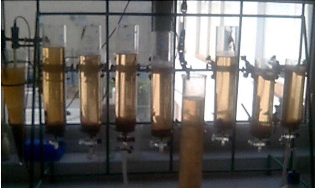
*Ensayo de Neutralización y Oxigenación de Aguas Ácidas Mineras iniciado por el Grupo TAR en octubre de 2010.*
