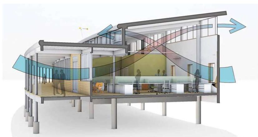
Figura 2.- Ejemplos de ventilación simple y cruzada.
