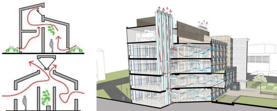
Figura 4.- Efecto chimenea o ventilación convectiva.
