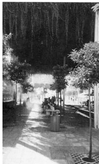
Figura 5: Vistas de los espacios abiertos de la Expo 92 durante la celebración del evento, en las que se pueden observar diferentes estrategias de enfriamiento pasivo puestas en juego: sombra, vegetación, evaporación, materiales. Fuente de las imágenes: J. López de Asiain, 2001, Arquitectura, ciudad y medioambiente.
