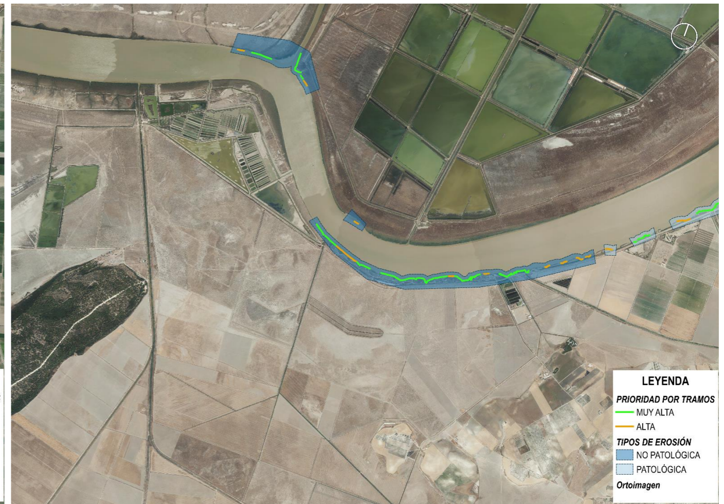
Figura 22. Zonas por tipo de erosión en el tramo El Yeso - Puntalete. Fuente: Elaboración propia, 2022
