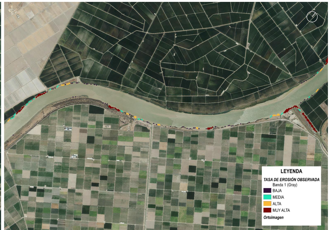
Figura 4. Tasa de erosión observada en el tramo La Horcada - La Mata. Fuente: Elaboración propia con base IH Cantabria, 2022
