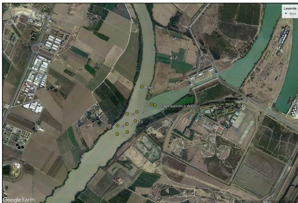
Ilustración 259. Diseño de malla de muestreo para el control de la pluma de turbidez en dragado. Fuente: Elaboración propia, 2022.
