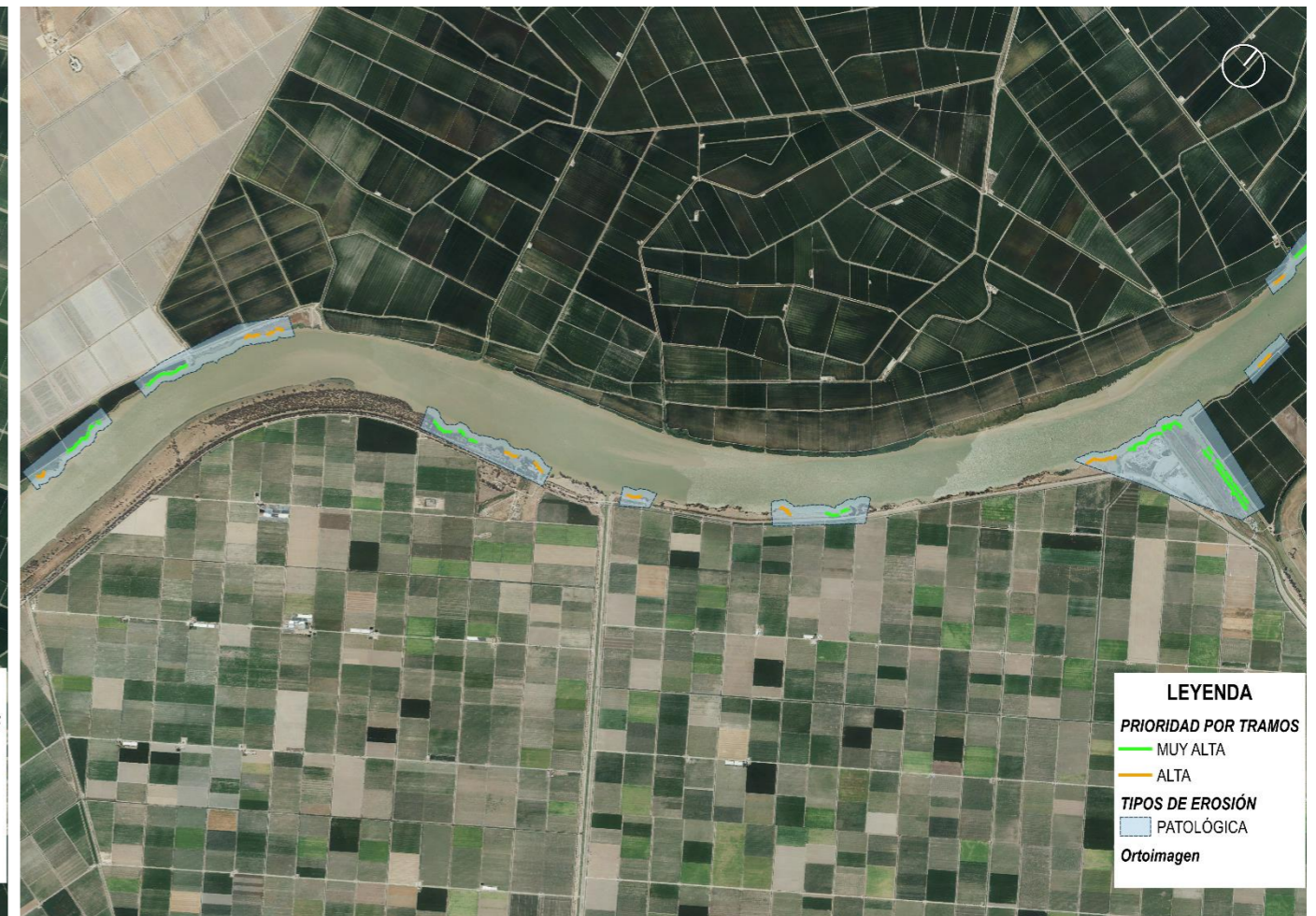
Figura 20. Zonas por tipo de erosión en el tramo La Horcada - La Mata. Fuente: Elaboración propia, 2022
