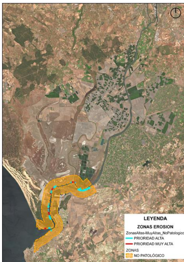
Ilustración 101. Zonas con riesgo de erosión no patológica, llamada erosión fluvial, sin que se excluya el segundo tipo, el patológico. Fuente: UTE con asesoramiento de UPC, 2022.
