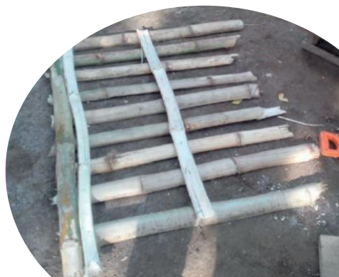
Ilustración 7. Rejas de desbaste en Kimpese, R.D. de Congo, diseño grupo Tar, autoconstrucción comunitaria.
