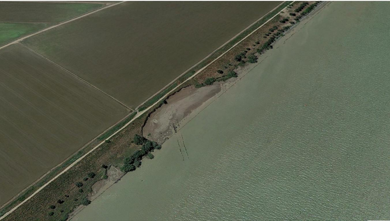
A la altura de la Puebla del rio la erosión de la orilla es grande, se propone una estrategia de estabilizar con gaviones y naturalizar con arena de dragado y compost de depuradora de aguas residuales que de soporte a la vegetación de ribera.
