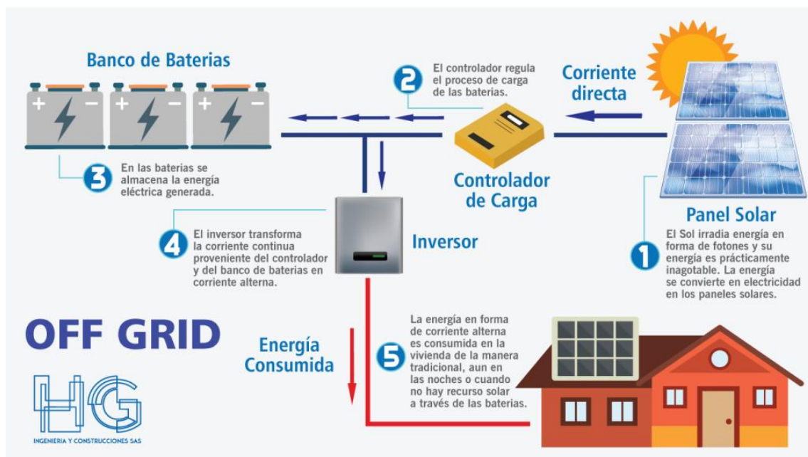
Figura 5 Componentes instalación off-grid Fuente hgingeneria.com
