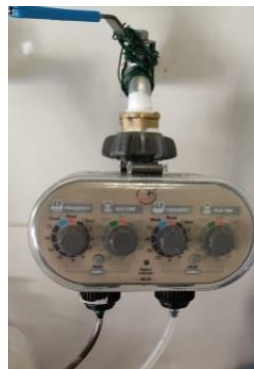
Figura 4.2: Programador de riego usado en el estudio ubicado en el laboratorio del Grupo Tar.
