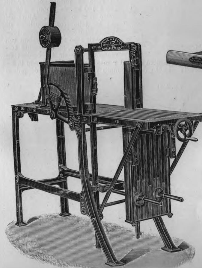
Máquina cortadora de un solo alambre.
