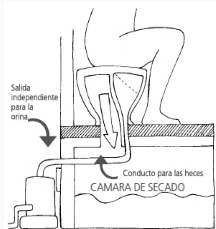
Figura 1: Esquema de eco-inodoro con separación de heces y orina
