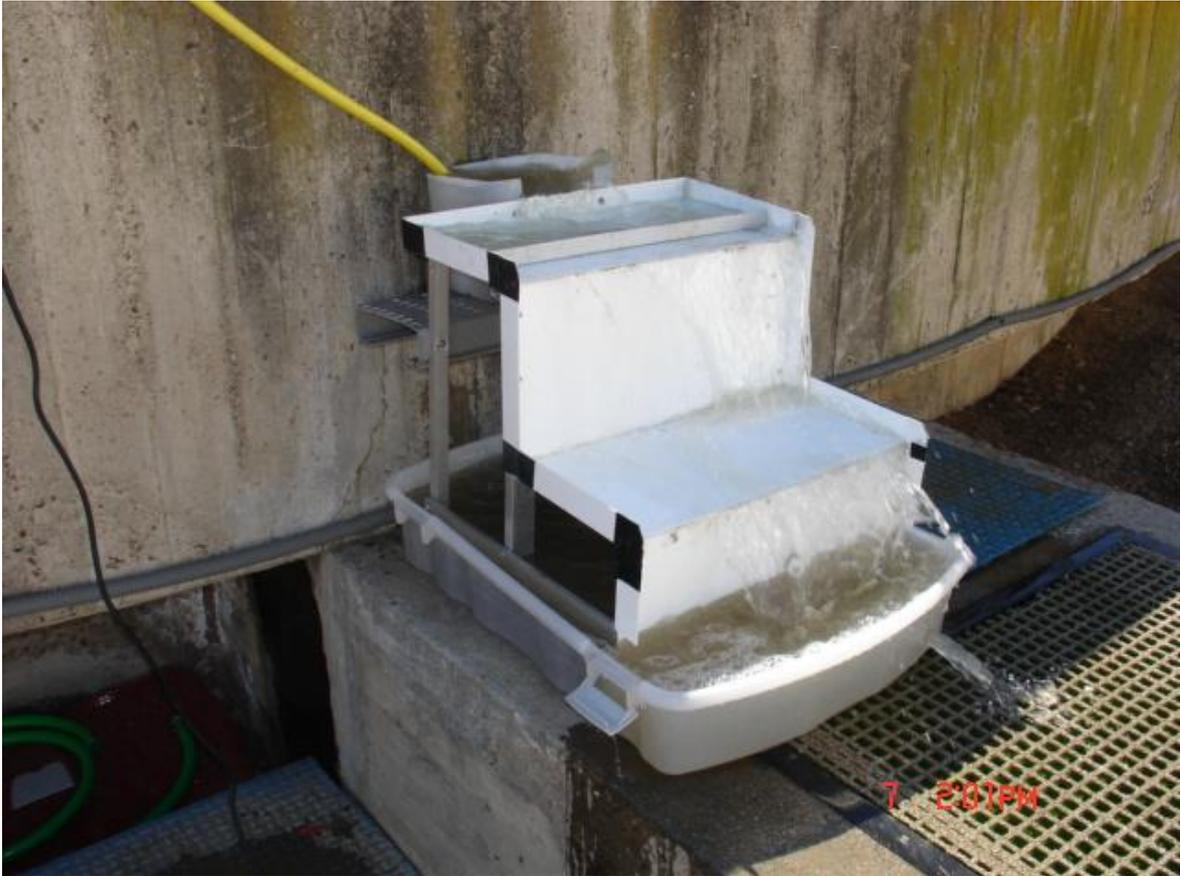
En esta foto se visualiza el mínimo caudal necesario para conseguir el llamado efecto cascada, que nos permite introducir aire en el sistema.
