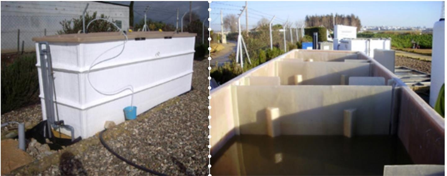
Figura 7.3.2. Fosa anaerobia piloto.
