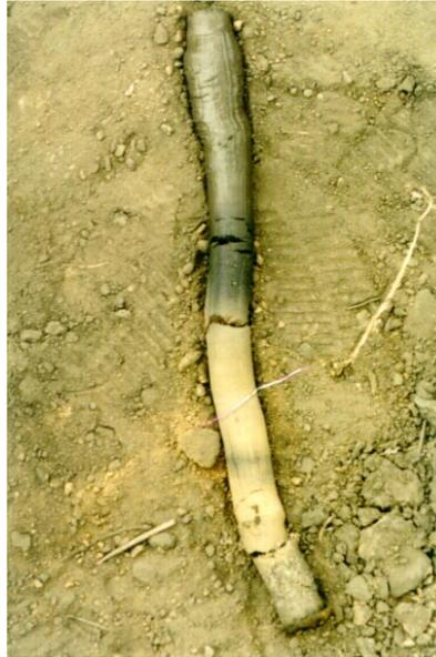
**Foto 2:** Columna de sedimento recogida con la barrena de metacrilato.
