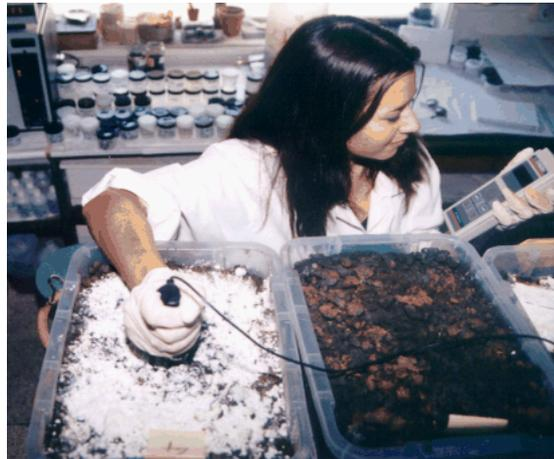
**Foto 2:** Control del pH en las cubetas de experimentación.
