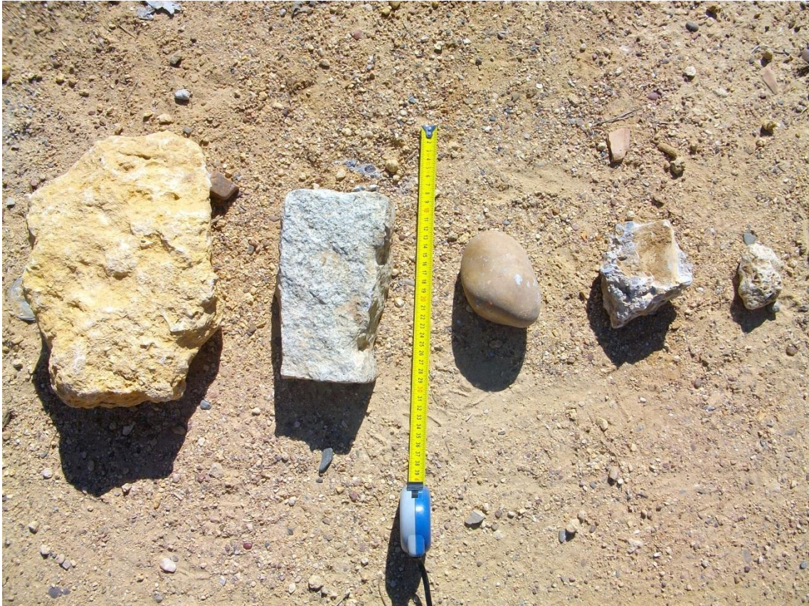
Fig. 6 – Muestra de los diferentes tamaños y formas de piedra usados. De izquierda a derecha: tamaño grande, mediano y las tres últimas, tamaño pequeño.
