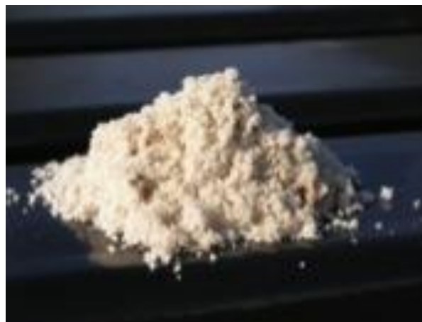
Figura 11. Estruvita granulada. Fuente: (Paques, 2007)
