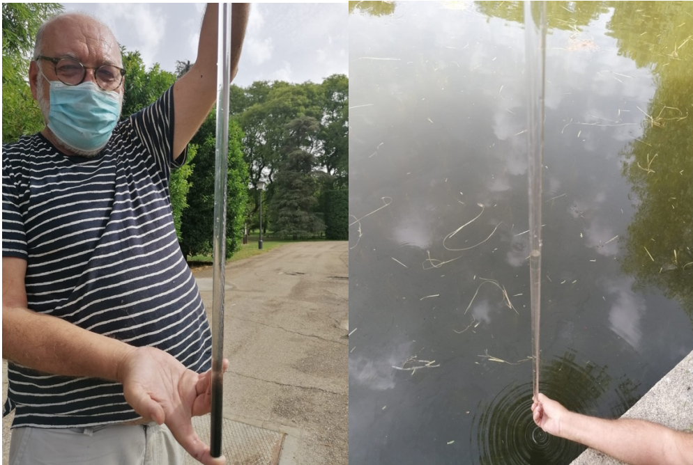
Ilustración 7. Fangómetro con muestras de la laguna del Parque de los Príncipes, tomadas el día 8 de julio 2020 en el entorno de la sobrealimentación observada y en zonas diferentes de la misma no sometidas a dicha presión de nutrientes.
