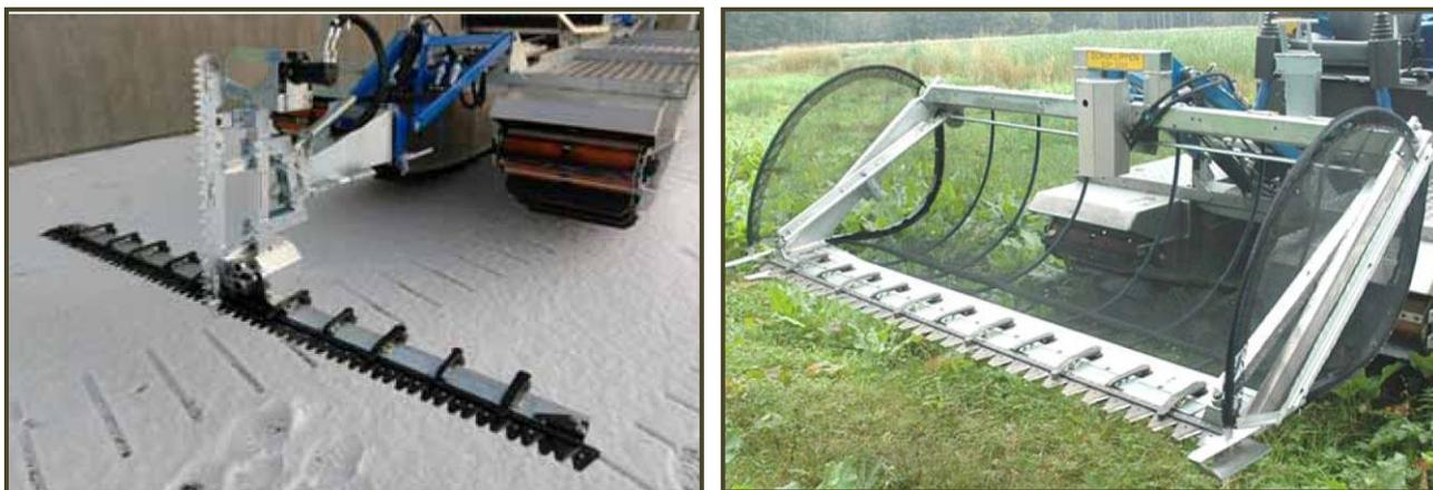
Unidad de corte Doro Cutter ESM 2100 (izq.) con una profundidad de trabajo de 0,5 metros y Doro Cutter ESM 2200 (drcha.) con una profundidad de trabajo de 0,8 metros, ambas con una anchura de corte de 2,1 m. aproximadamente (marca Truxor).
