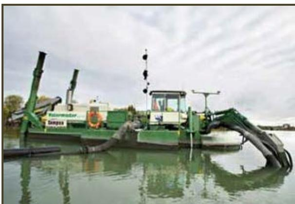
*Draga de succión trabajando con bombeo encauzado del material dragado.*
