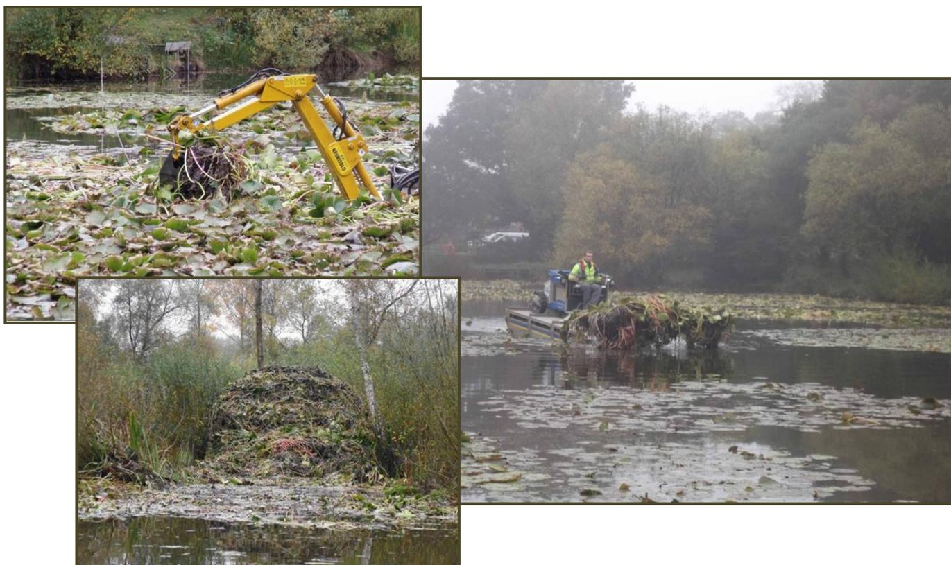
*Imágenes de la extracción, transporte y apilado de nenúfar utilizando un anfibio marca Truxor donde se puede observar la retirada de lodos junto con la planta, folleto informativo Water Lily Control empresa Aquatic Soutlions UK*
