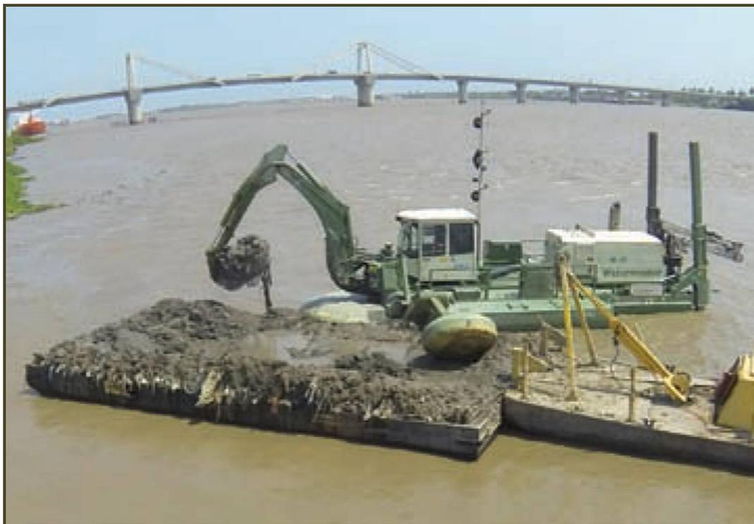
Imagen de draga anfibia vertiendo sobre un contenedor flotante el cual es transportado por una embarcación a tierra.
