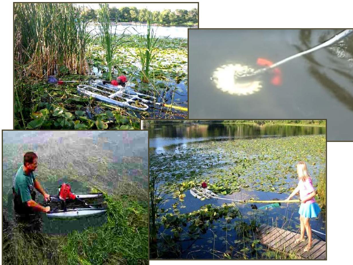
Desbrozadora manual DVG para uso dentro del agua y mini-pontón de transporte.
