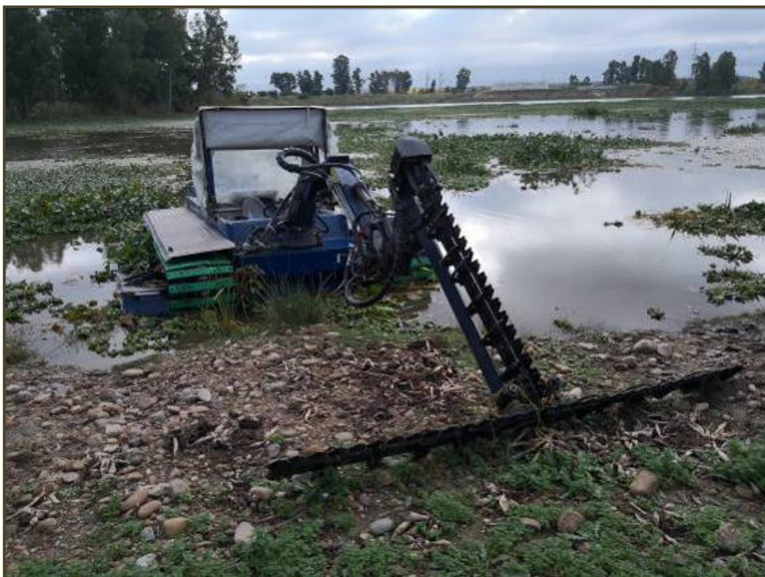
*Imagen Vehículo Anfibio (Amphibious Boat) marca BERKY modelo 6480. En esta imagen tiene acoplado una cuchilla de corte, pero dispone de diferentes accesorios intercambiables para realizar distintas operaciones.*
