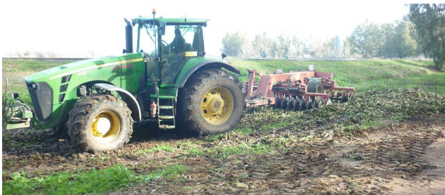
Fig. 9 Gestión de restos de camalote con grada pesada
