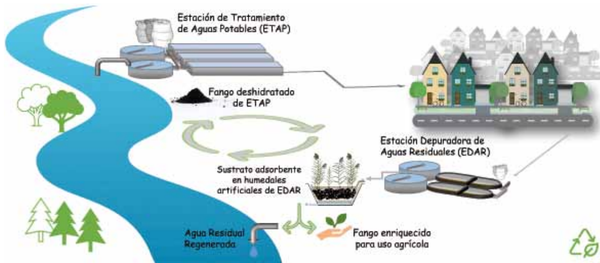
FIGURA 1. Proceso circular de aprovechamiento de fango de ETAP como sustrato de humedales artificiales empleados como tratamiento de afino en EDAR.
