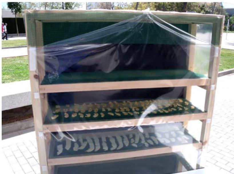
*Figura 78. Cámara de secado cerrada con velcro*
