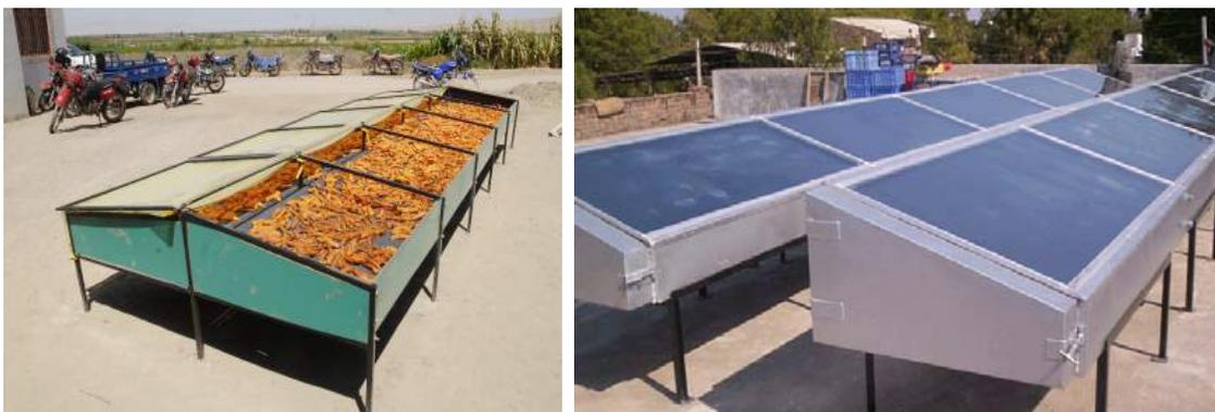
Figura 18. Deshidratadores túnel comerciales (Sharma, P. D. 2015)
