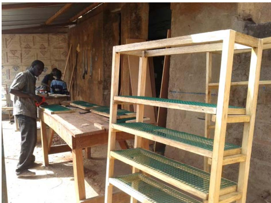
*Figura 107. Primer deshidratador con las bandejas montadas y operarios trabajando sobre las bandejas de un segundo deshidratador*
