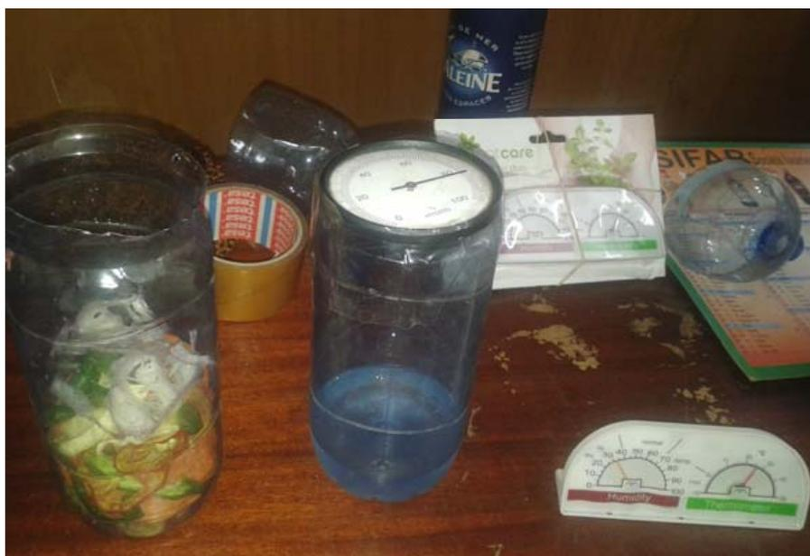
Figura 112. Higrómetros para medir la actividad del agua
