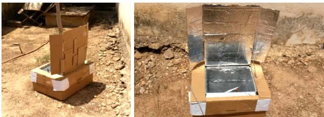
*Figura 126. Prototipo de horno solar construido en cartón y probado en Burkina Faso*
