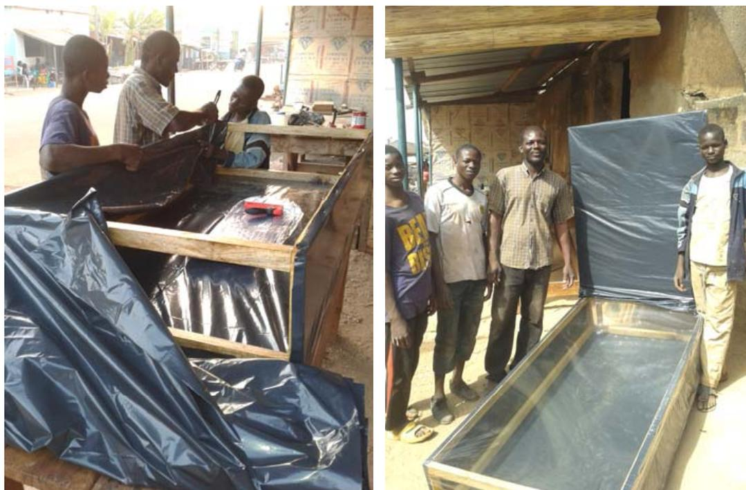
*Figura 108. Proceso de colocación del plástico sobre la estructura del colector y equipo completamente terminado*
