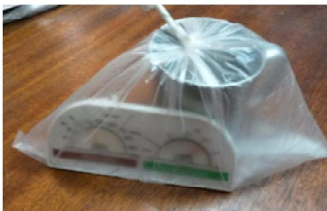
Figura 121. Calibración de un punto de higrómetros de bajo coste realizada en Burkina Faso enero de 2015
