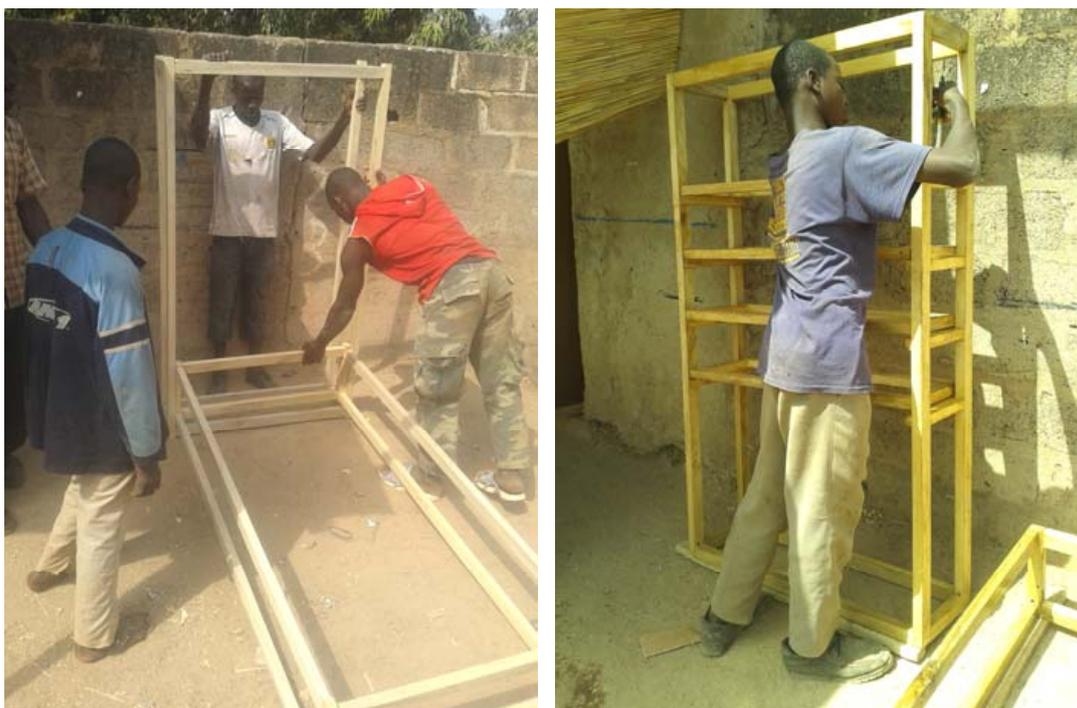
*Figura 106. Proceso de construcción del primer deshidratador solar en Burkina Faso*
