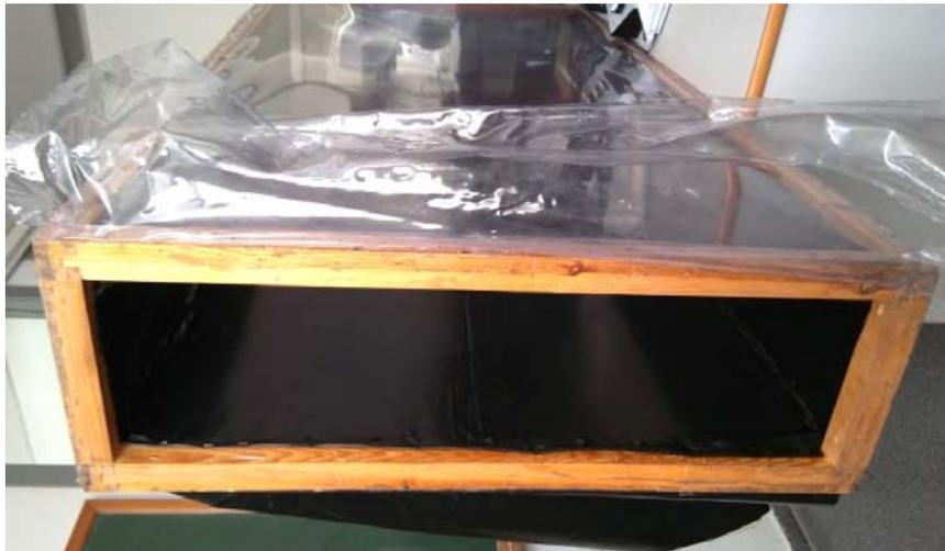
*Figura 51. Zona de salida del aire calentado en el colector*
