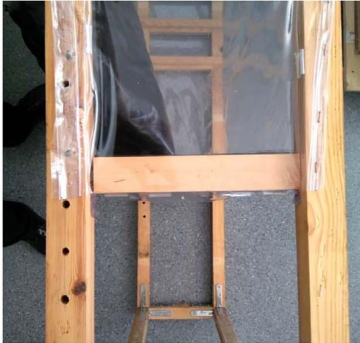
Figura 59. Orificios para el pasador que une las dos partes del deshidratador
