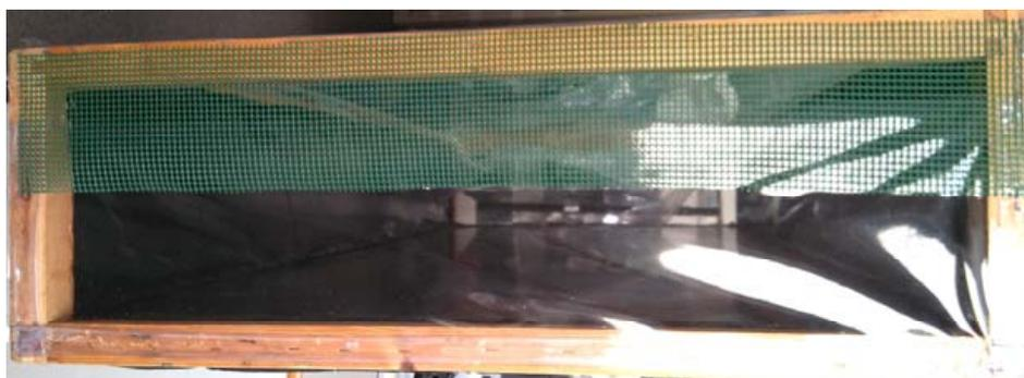
*Figura 50. Frontal del colector, cerrado con rejilla y plástico transparente*
