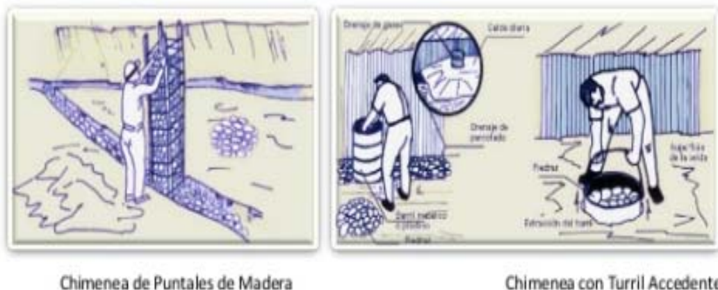
Figura 31 Construcción de Chimeneas
