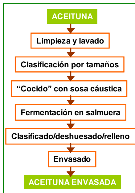
Figura 5 Fases del proceso de elaboración de la aceituna de mesa.
